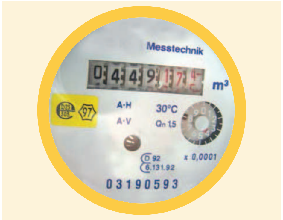
Nach dem neuen Mess- und Eichgesetz muss Messtechnik wie Wasser- oder Gaszähler bei der zuständigen Behörde angemeldet werden.
